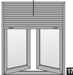
Δίφυλλο ανοιγόμενο - ανακλινόμενο παράθυρο με ρολό Two sash tilt & casementwindow with roller shutter
